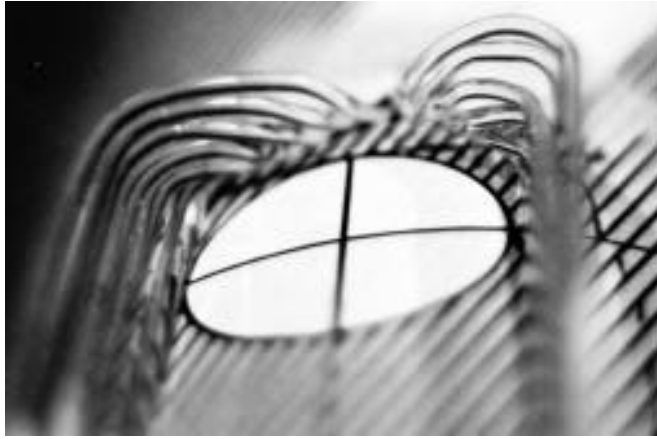
Abbildung 27: Formgebung eines Faserbündels im Stutzenbereich (Blick in Strahlrichtung). Der weiße Kreis mit dem schwarzen Kreuz entspricht dem Querschnitt eines Targetstutzens (38 mm Durchmesser).
