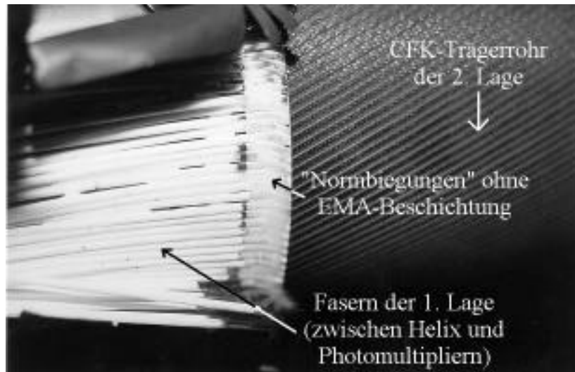
Abbildung 28: Bereich um z=0 vor Verkleben der Fasern der zweiten Helixlage. Gut zu erkennen sind die Normbiegungen und der Wechsel im Wicklungssinn von erster und zweiter Helixlage.
